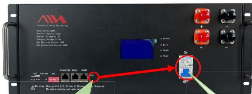
2. Appuyez sur le bouton "Reset Switch" situé sur le panneau avant et maintenez-le enfoncé pendant environ 6 secondes jusqu'à ce que les 6 voyants LED s'allument puis s'éteignent pour terminer l'arrêt.
