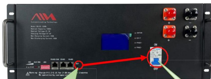
1. appuyez sur le bouton "reset switch" situé sur le panneau avant et maintenez-le enfoncé pendant environ 1 seconde
